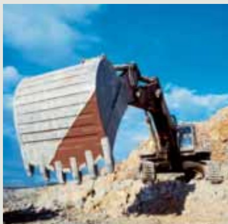
SSAB är ledande tillverkare av höghållfast tunnplåt och kyllda stål som bl a används i grävsopor för att maximera livslängd, lastförmåga och driftsäkerhet. Skopan är tillverkad av Hardox-stål.
