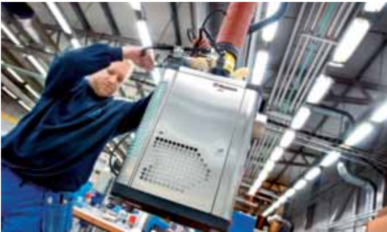
Packning av avfuktningssaggregat efter genomförd testning vid Munters fabrik i Tobo i Uppland.
