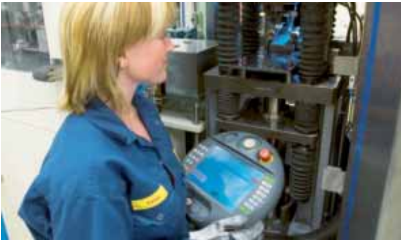
Pressning av hårdmetallskär för skärande metallbearbetning vid Sandviks anläggning i Gimo i Uppland.
