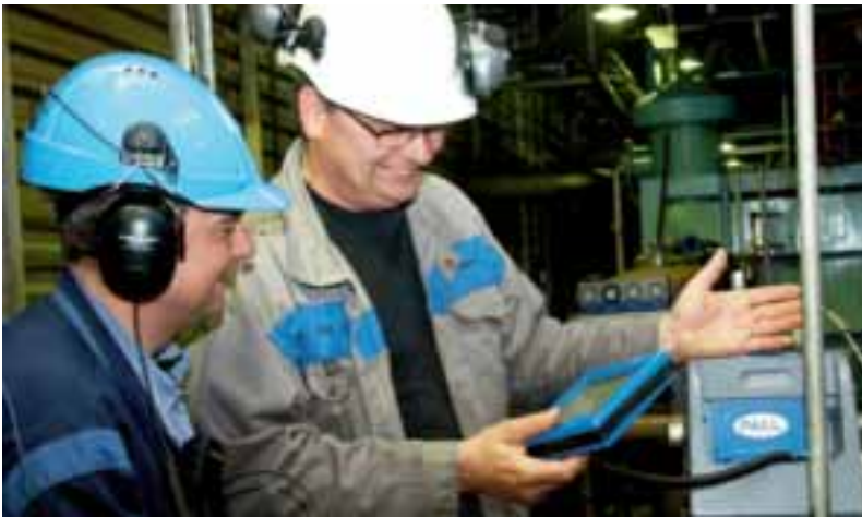
Servicepersonal från Indutrade mäter renheten i filter som ingår i hydraulik- och smörjoljesystemet på pappersbruk.
