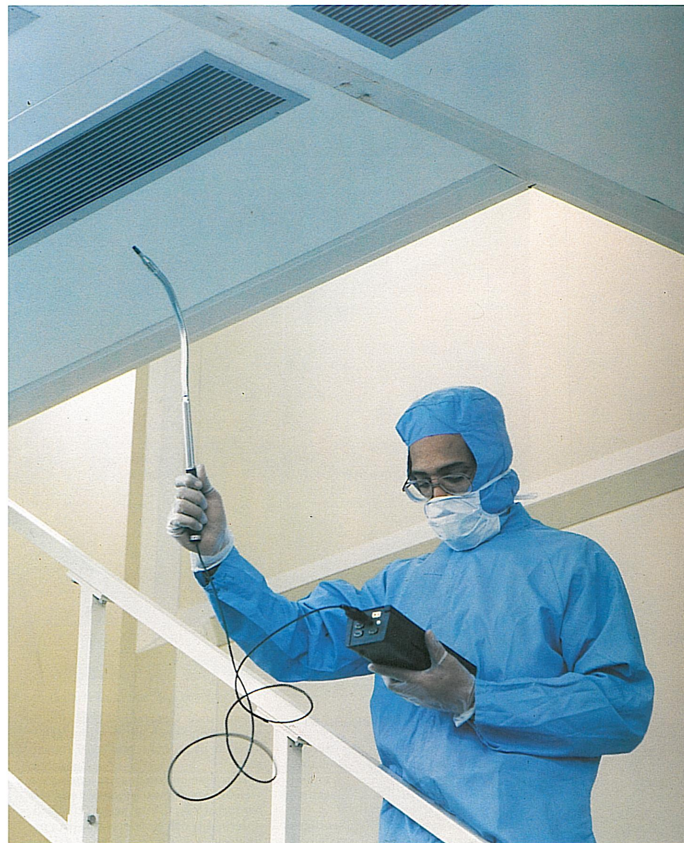
Luftkvaliteten i ett kliniskt rent rum kontrolleras med holländska Hitmas kvalificerade mätinstrument.
